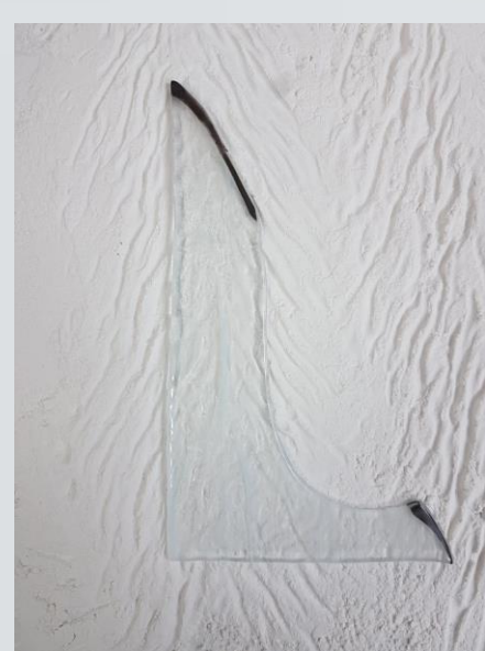
Pose d'un verre possédant le bon motif sur un lit de plâtre pour la prise d'empreinte et déformation du verre à 750°C
