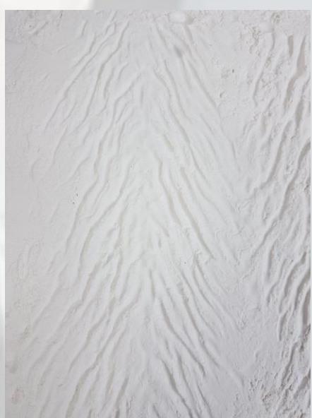
Pose d'un verre possédant le bon motif sur un lit de plâtre pour la prise d'empreinte et déformation du verre à 750°C
