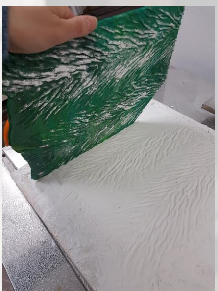
Pose d'un verre possédant le bon motif sur un lit de plâtre pour la prise d'empreinte et déformation du verre à 750°C
