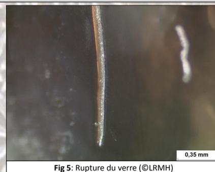
Fig 5: Rupture du verre (©LRMH)
