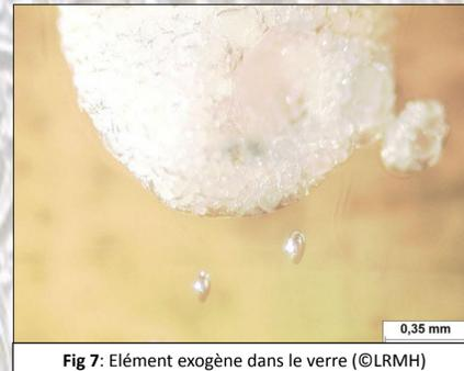
Fig 7: Élément exogène dans le verre (©LRMH)
